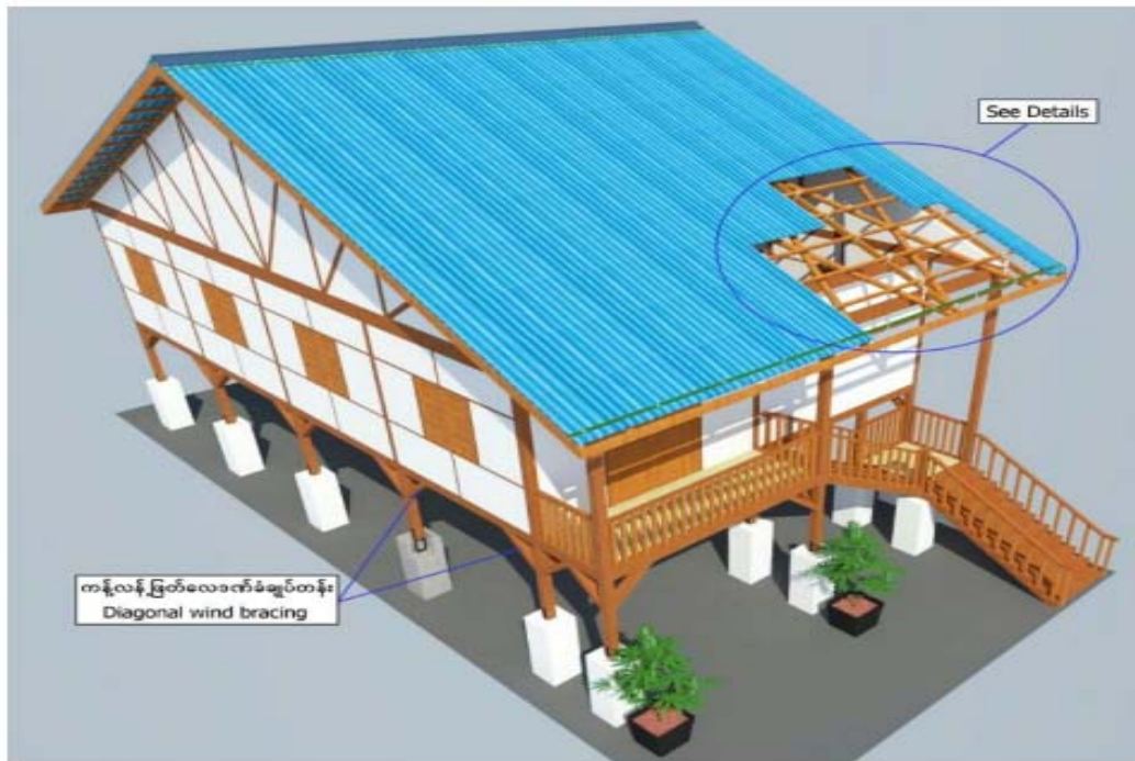
ကန်လန်ဖြတ်လေဒဏ်ခံချုပ်တန်းများ ထည့်သွင်းထားပုံ ပုံ (၁၀)
